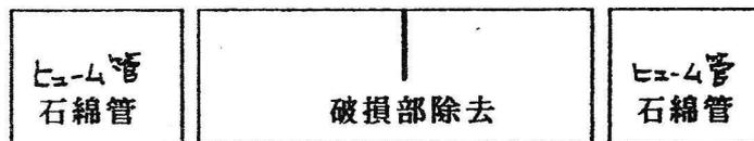
**3. 破損部を塩ビ管等に取り替え(Y-2型使用の場合)**
